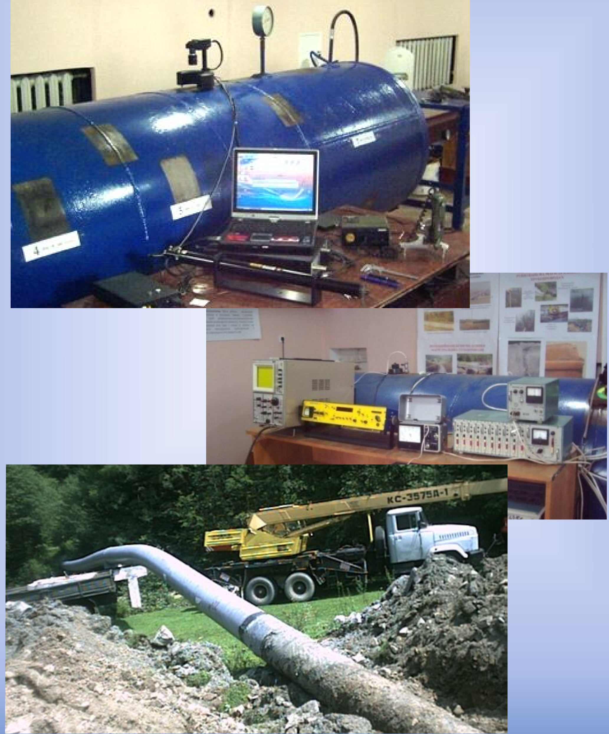
Дослідно-вимірювальний комплекс для експериментального визначення характеристик напружено-деформованого стану в зоні основного металу і різноманітних кільцевих зварних з'єднань труб МТ.
